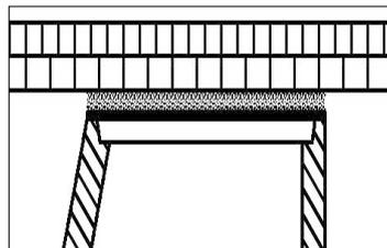
1. Schacht mit Belag überbauen und prov. Schachtabdeckung vorsehen
