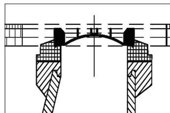
2. Neue Schachtabdeckung auf UK Deckschicht versetzen
